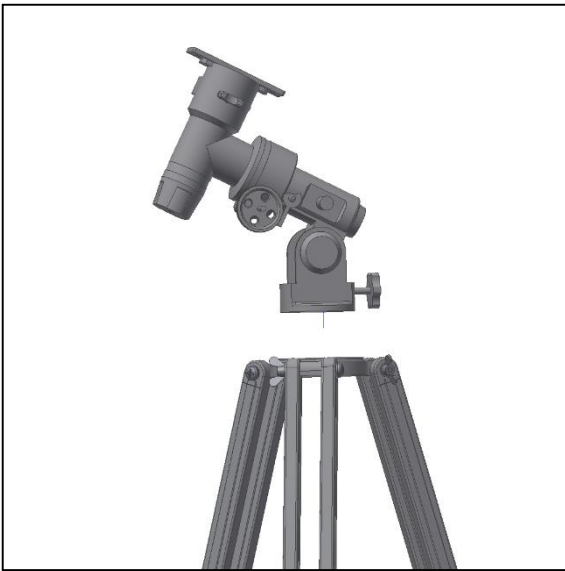
Fig. 4. Mise en place de la monture équatoriale
